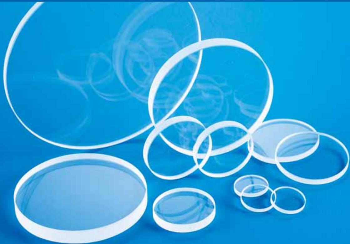
Composto per il 96% da silice pura il vetro VYCOR® è ideale per applicazioni in presenza di alte temperature, tanto che può essere usato in modo continuo fino a 900°C e per brevi periodi fino a 1200°C. Grazie al suo coefficiente di dilatazione molto basso il VYCOR® garantisce anche un'eccellente resistenza allo shock termico. Le spie VYCOR® possono essere fornite in forma circolare, quadrata e rettangolare. La dimensione massima è di 310 mm.
